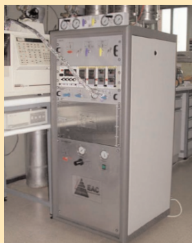
Instalación de producción de hidrógeno mediante reformado de hidrocarburos. (Foto: CSIC)
