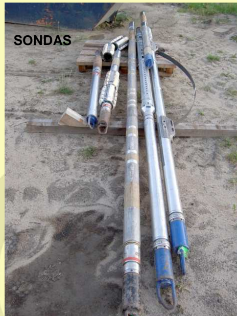
Sondas: Pex-HRLA, densidad, neutron porosity GR y resistividad/microresistividad
